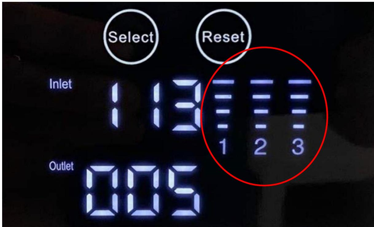
Filter (Stufe 1+3), sollten in Anlehnung an die DIN 1988, alle 6 Monate, die Osmosemembran alle 36 Monate gewechselt werden, bzw. nach Bedarf.
